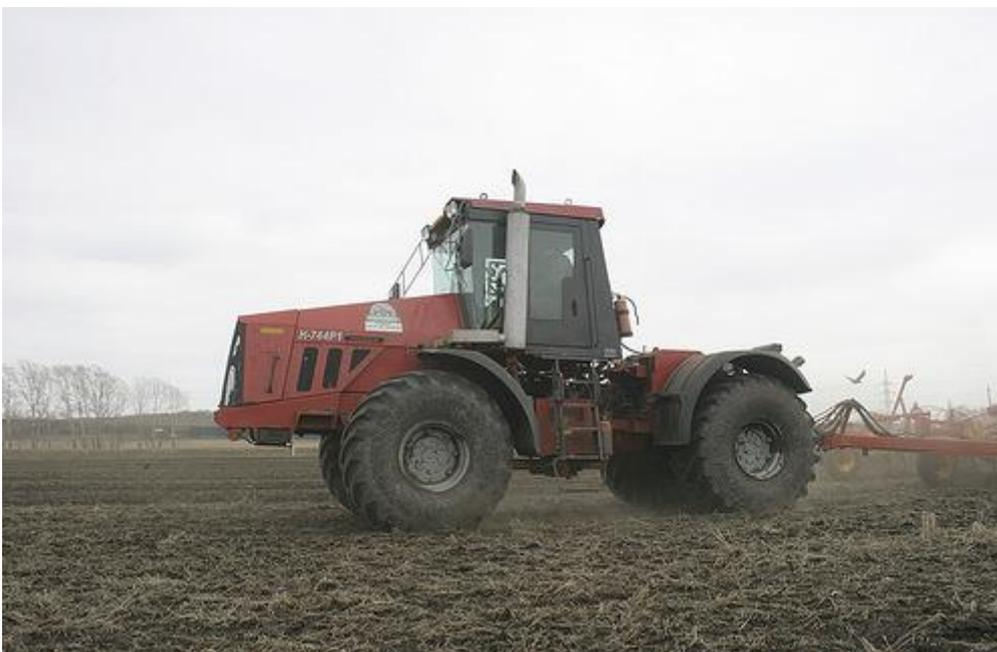
"Кировец" К-744Р1 "Премиум". Эта модификация появилась в линейке сельскохозяйственных "Кировцев" в 2012 году. Основное отличие - двигатель Cummins 6LТАА8.9. Рабочий объем двигателя 8,9 л, номинальная мощность 306 л.с. при 2000 об/мин, максимальный крутящий момент 1268 Нм.
