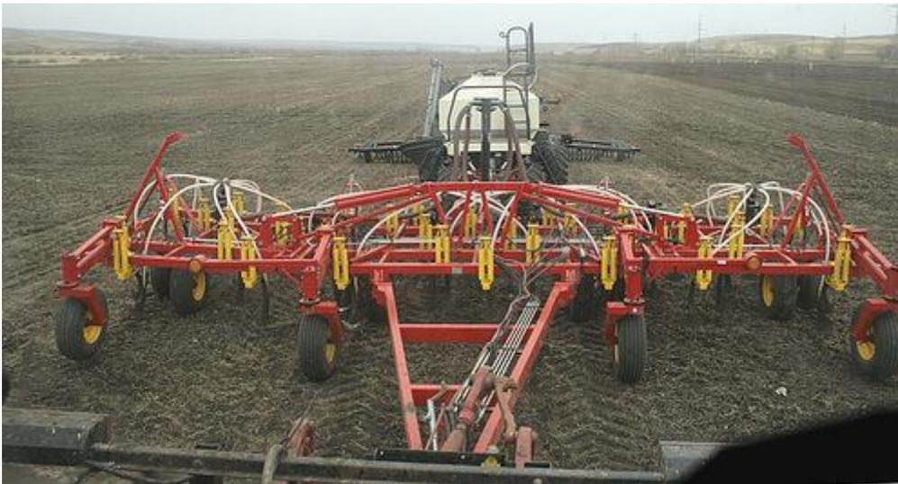
При ширине захвата сеялки 9 метров агрегат легко контролируется оператором благодаря хорошей обзорности с рабочего места.
