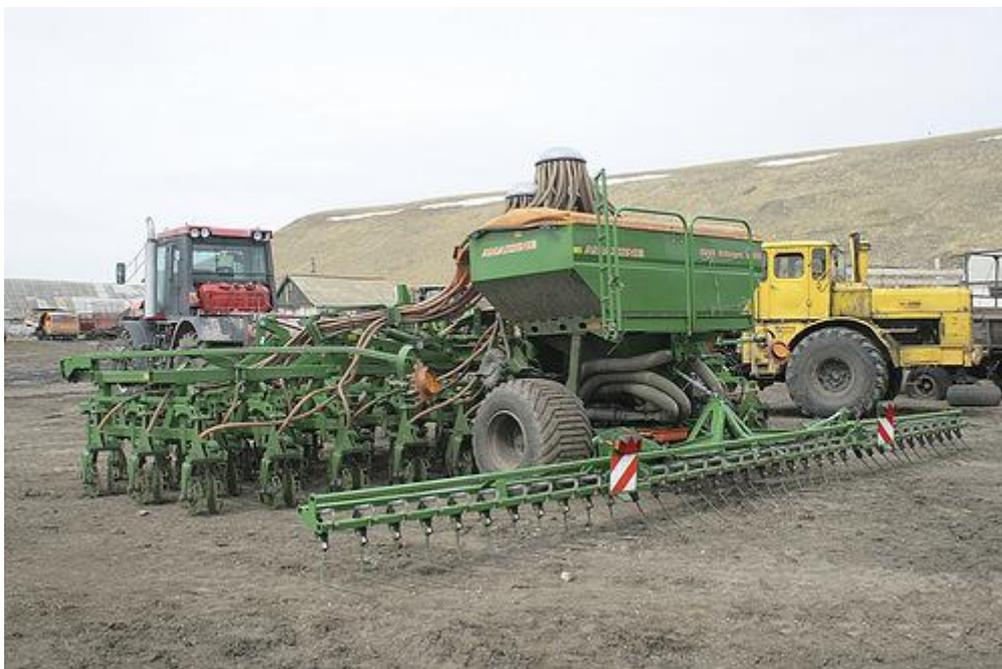
DMC Primera 9000 - универсальная высокопроизводительная сеялка, подходит не только для мульчированного и прямого посева, но и для посева по вспашке. Параметры: ширина захвата 9,0 метров, необходимая мощность трактора от 270 л.с., полная масса 12500 кг.
