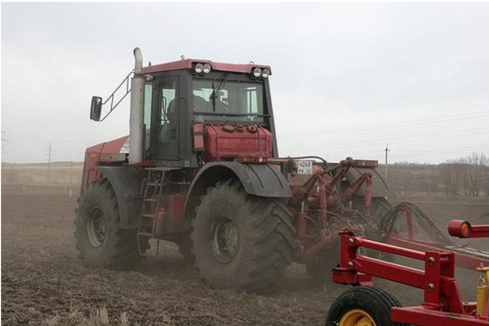
Стандартная гидросистема рабочего оборудования тракторов "Кировец" позволяет без проблем агрегатироваться практически со всеми посевными комплексами, представленными на российском рынке. Аксиально-поршневой насос переменной производительности обеспечивает подачу до 180 л/мин, для соединения с гидросистемой прицепных машин есть четыре гидролинии. Для гидромотора привода вентилятора предусмотрены линии свободного слива и дренажа.
